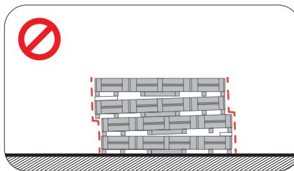
Curare il perfetto allineamento degli imballi in fase di impilaggio onde evitare problemi di stabilità della pila.
