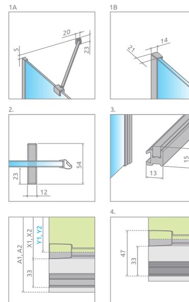
Zuhanytálcára szerelteskor a Furo zuhanykabin helyigénye min. 47 mm (lásd: 4. technikai rajz)
