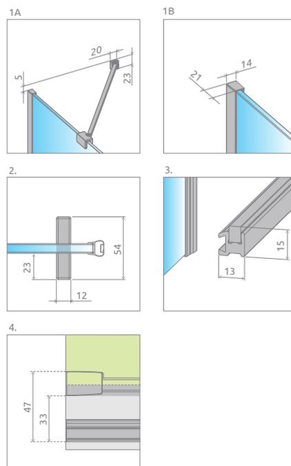
Zuhanytálcára szerelékör a Furo zuhanykabin helyigénye min. 47 mm (lásd: 4. technikai rajz)
