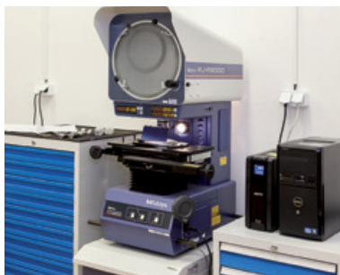
Profil projektor. Minőség-ellenőrzési laboratórium.
