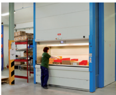
KARDEX. Nagy kapacitású automata tároló rendszer.
