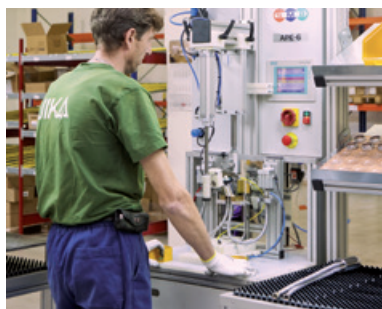
Levegőteszt az összeszerelő soron.
